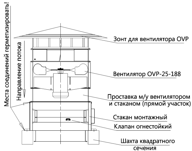
установка на монтажном стакане с огнестойким клапаном
