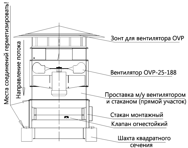
установка на монтажном стакане с огнестойким клапаном
