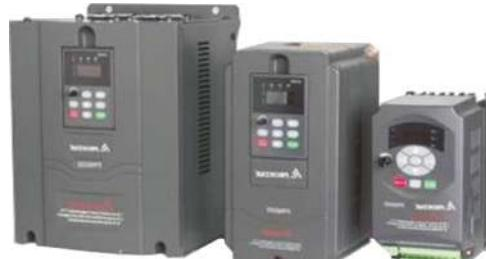
Преобразователи частоты являются высокотехнологичными устройствами, обладающими высокой точностью и широким диапазоном регулирования. С помощью частотного преобразователя можно осуществлять регулирование производительности вентилятора, плавный пуск, защиту от перегрузок, задание скорости вращения вентилятора при помощи аналогового сигнала 0...10В, 4...20mA от удаленного управляющего источника или при помощи потенциометра.
