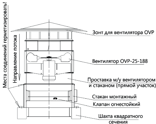
установка на монтажном стакане с огнестойким клапаном
